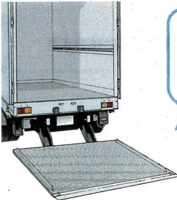
円弧を描くように移動(昇降)し、接地時に昇降板が傾く特性があります
